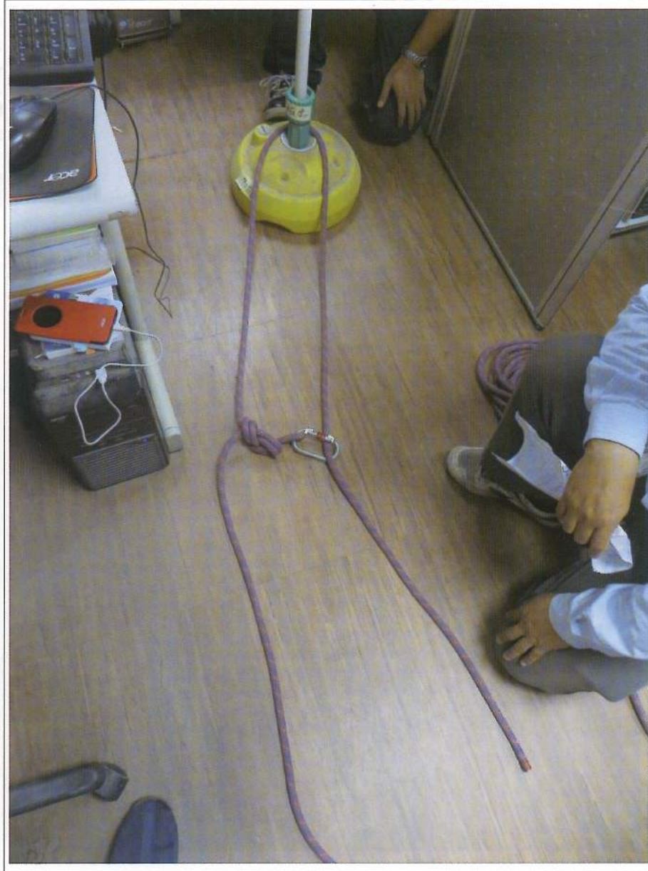
模擬疑似繩索固定方式（救命繩未用，且工作繩受力，致使繩索鬆脫）
